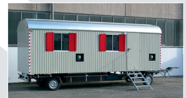
Weiro® RASANT Typ BM-D 24 S, 2-achsig, mit 7,0 m Aufbauhöhe, lackiertem Fahrgestell, DIN-Zugöse und Druckluftbremse, Gasinstallation, Gerätekasten unter dem Chassis
