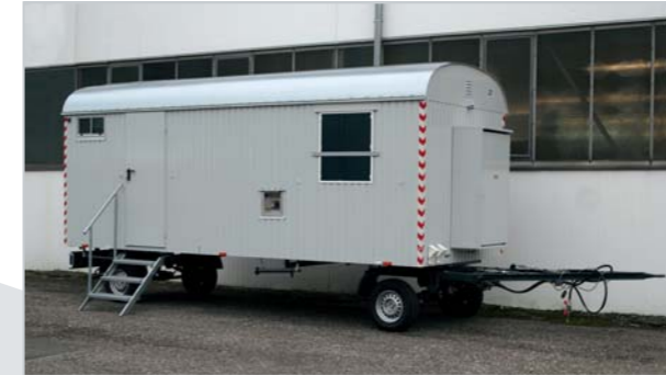
Weiro® RASANT Typ BM-C 23 S, 2-achsig, mit 6,0 m Aufbauhöhe, lackiertem Fahrgestell, DIN-Zugöse und Druckluftbremse, Sonderlackierung, Gasinstallation
