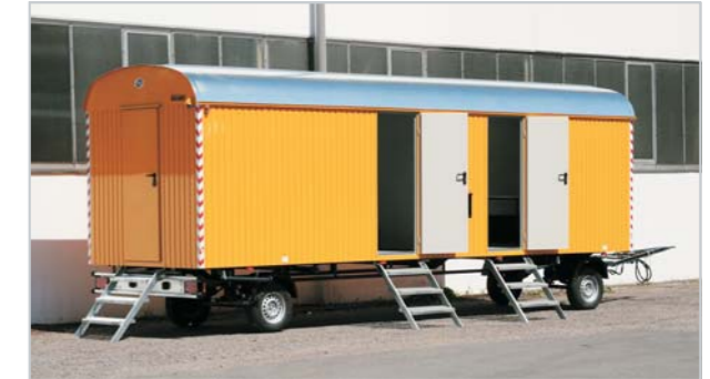
Weiro® RASANT Typ BM-E 23 S, 2-achsig, mit 8,0 m Aufbauhöhe, lackiertem Fahrgestell, DIN-Zugöse und Druckluftbremse, mit Aufenthalts-, Lager- und Geräteraum, jeweils mit separater Tür
