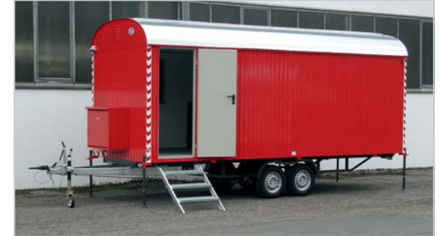
Weiro® RASANT Typ BME-F 23 ST, Tandemachse, mit 6,0 m Aufbauhöhe, lackiertem Fahrgestell, DIN-Zugöse, Sonderlackierung, Gasinstallation
