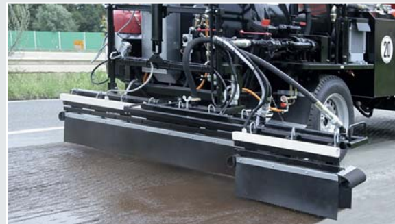
Optional: Spritzrampenverbreiterung auf 2,40 m Spritzbreite, wahlweise mit elektropneumatischer Einzeldüzenschaltung
