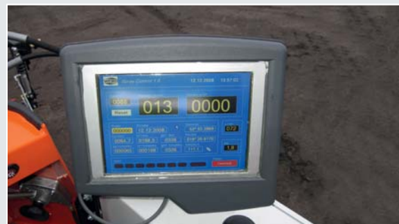
Optional: elektronisches Mengenerfassungs- und Protokolliersystem zur Erfassung der ausgebrachten Bindemittelmenge, für jede Baumaßnahme einzeln erfasst als Tages- und Gesamtmenge
