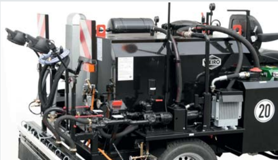
Optional: Bindemittelbehälter mit Isolierung und elektrischer Zusatzheizung, elektropneumatische Einzeldüzenschaltung sowie Arbeitsscheinwerfer
