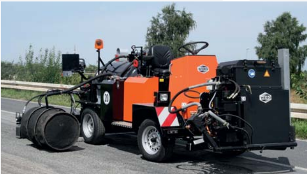
Selbstbefüllung durch Ansaugen: TM 804 SH, zusätzlich ausgestattet mit Vorbautenträger sowie Naht- und Randanspritzmodul KSM 100
