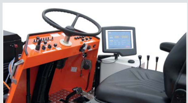
Ergonomisch gestalteter Bedienerplatz, optional mit dem elektronischen Mengenerfassungs- und Protokollier-system zur Erfassung der ausge-brachten Bindemittelmenge, einzeln als Tages- und Gesamtmenge
