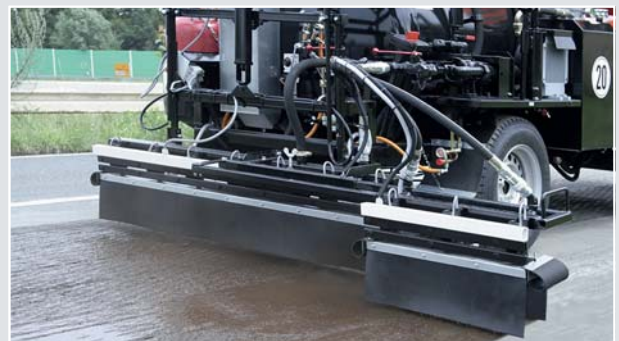
Optional: Spritzrampenverbreiterung auf 2,40 m Spritzbreite, wahlweise mit elektropneumatischer Einzeldüzenschaltung
