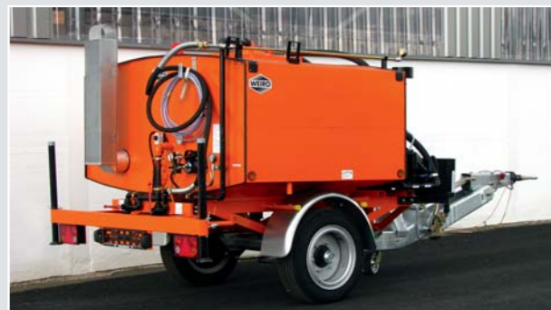
HK 1000 A, montiert auf einem 1-Achsanhänger, mit 3.000 l Emulsionstank mit Tankisolierung, Tankbeheizung über einen thermostatgesteuerten Propangasbrenner
