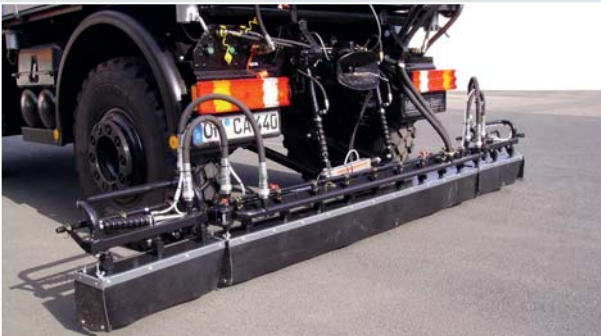
Vollzirkulationsspritzrampe mit 2 seitlich ausklappbaren Auslegern, Ausleger u. Düsen sind einzeln manuell zuschaltbar.
