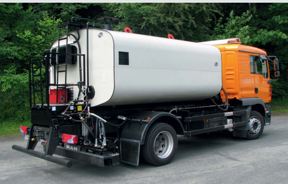
HK 1000 PM, montiert auf MAN, mit 8.000 l Emulsionstank mit Tankisolierung, Tankbeheizung über Automatik Öl-Brennersystem, Spritzrampe auf 3,60 m teleskopierbar, mit hydraulischer Rampenhöhenverstellung
