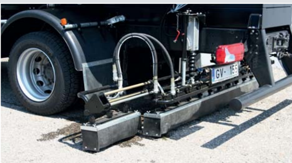
Vollzirkulationsspritzrampe mit 2 seitlich teleskopierbaren Auslegern, einzeln steuer- und zuschaltbar, mit hydraulischer Rampenhöhenverstellung. Spritzbreite bis 3,60 m. Alle Düsen einzeln zuschaltbar.
