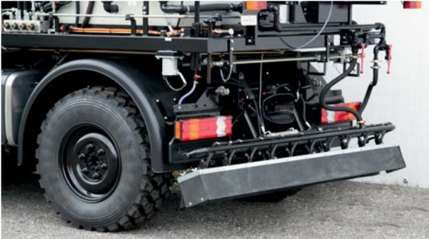
Spritzrampe in Fahrzeugbreite, montiert an der Dreipunkthydraulik des Unimogs.
