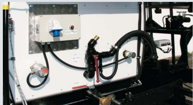
Die elektrische Zusatzheizung des Bindemittelanks erlaubt das Halten der Bindemitteltemperatur über Nacht oder während längerer Arbeitspausen und schont so das Bindemittel.
