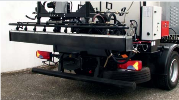
Die Höhenverstellung der Spritzrampe erfolgt per Handkurbel oder mittels Pneumatik- oder Hydraulikzylindern vom Fahrersitz aus.
