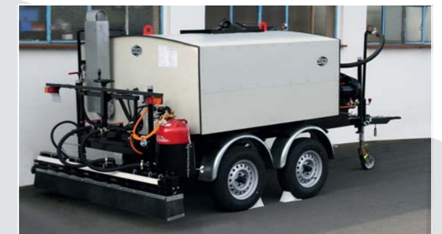
HK 1000 A, montiert auf einem Tandem-Anhänger, mit 2.000 l Emulsionstank mit Tankisolierung, Tankbeheizung über einen thermostatgesteuerten Propangasbrenner, Spritzrampe 2,20 m mit elektropneumatischer Einzeldüschaltung
