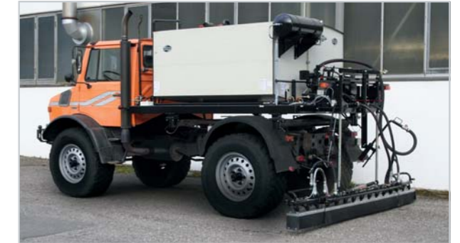
HK 1000 PH montiert auf MB Unimog mit 2.000 l Emulsionstank mit Tankisolierung, Tankbeheizung über einen thermostatgesteuerten Propangasbrenner, Spritzrampe 3,60 m
