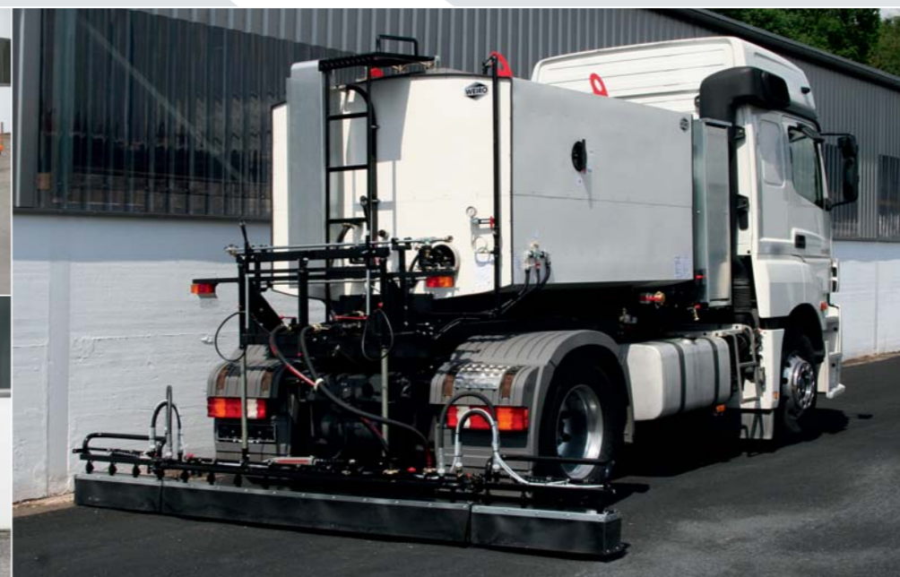
HK 1000 PM montiert auf Mercedes Benz mit 4.000 l Emulsionstank mit Tankisolierung, Tankbeheizung über einen thermostatgesteuerten Propangasbrenner, elektrischer Zusatzheizung, Spritzrampe 3,60 m
