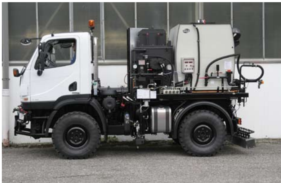
Geeignet auch für C60BP1S: universelles Weiro-Rampenspritzgerät der Baureihe HK 1000 PH mit einem 2000 l fassenden, wärmeisolierten Emulsionstank und einem Aufbaumodul zur Naht- und Randanspritzung mit Heißbitumen.
