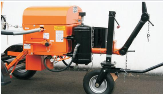
Höhenverstellbares, klappbares Stützrad mit Handzugrohr und Klotzfallbremse.
