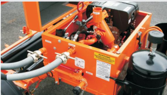
Motor-Pumpeneinheit zum hydraulischen Antrieb der Bindemittelpumpe in abschließbarem und schalldämmtem Motorraum.
