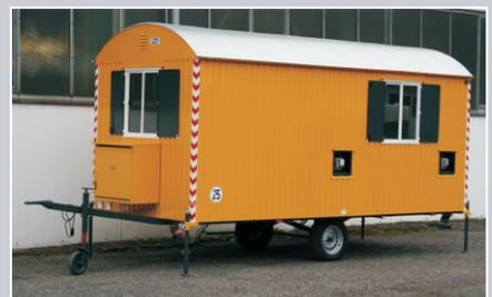
WEIRO<sup>®</sup> Baustellenwagen Sinus Typ A 11 - A 41, einachsig mit DIN-Zugöse, bis 25 km/h, von 3,0 m - 5,0 m Aufbauhöhe
