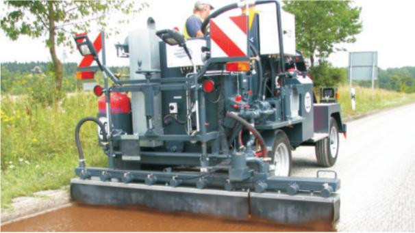
Qualitätsbestimmend: die Ausbringung des Bindemittels erfolgt in genauer Dosierung durch die kontrollierte Fahrgeschwindigkeit und den vorgewählten Spritzdruck bei definierter Düsengröße
