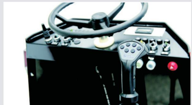
Ergonomisch gestalteter Bedienerplatz, mit Fahrhebel mit elektronischer Geschwindigkeitsregulierung, optional mit WEIRO® **Spraycontrol V3**, dem elektronischen Mengenerfassungs- u. Protokolliersystem
