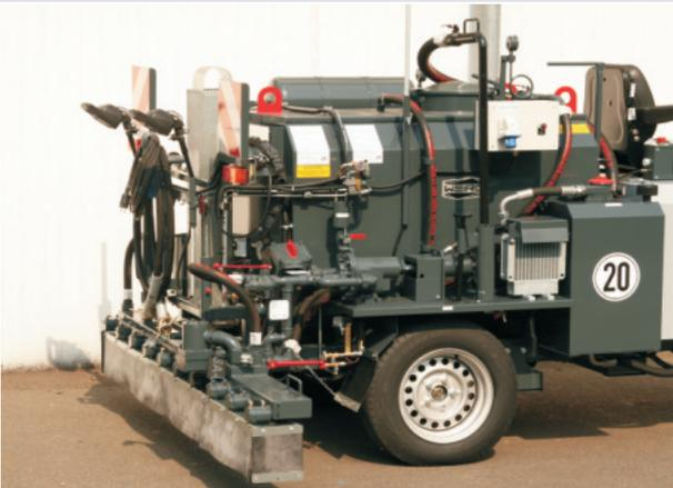
Doppelwandiger, isolierter Bindemittelbehälter, optional mit elektrischer Zusatzheizung und Arbeitsscheinwerfern
