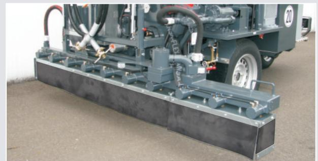
Spritzrampe mit elektropneumatischer Einzeldüsen schaltung, optional: seitlich schwenkbare Verbreiterung
