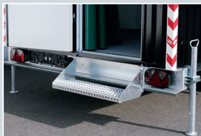
Robuste, feuerverzinkte Trittstufe
