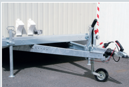
Fahrgestell aus verzinkten Leichtbauprofilen , verzinkte Eckrohrstützen
