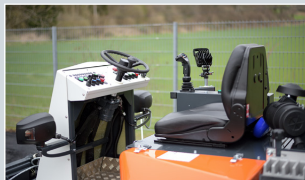
Ergonomisch gestalteter Bedienerplatz mit Joystick zur Fahrsteuerung. Zusätzlicher Arbeitsscheinwerfer zur bestmöglichen Ausleuchtung des Arbeitsbereichs.
