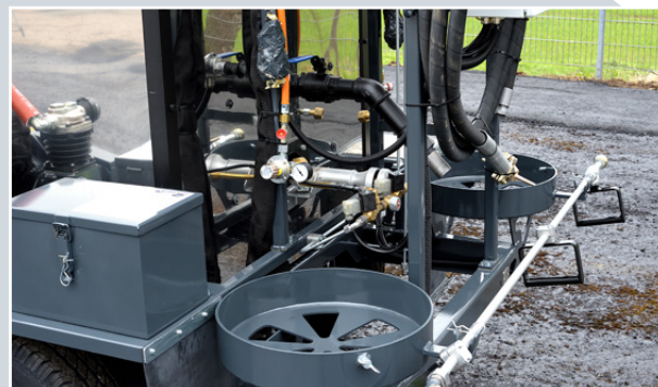
Leistungsstarke Gasbrenneranlage, thermostatgesteuert mit automatischer Zündung.
