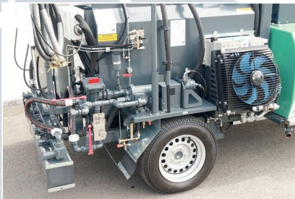
Kompakte und wartungsfreundliche Anordnung des Pumpenaggregats, der Filter und Rohrleitungen.
