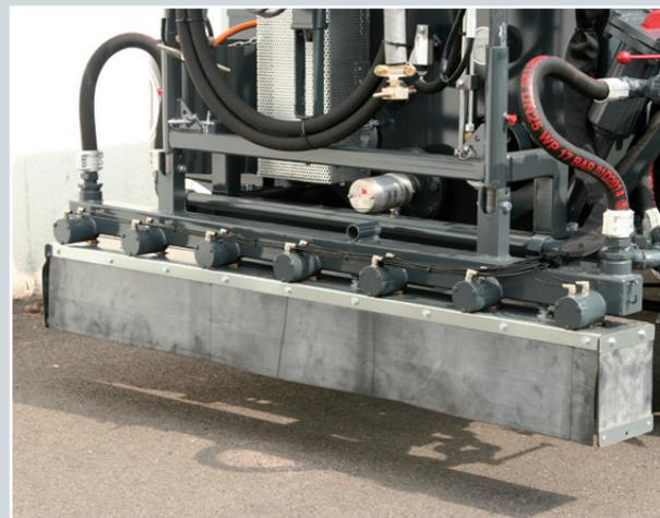
Spritzrampe mit elektropneumatischer Einzeldüsen schaltung, optional: seitlich schwenkbare Verbreiterung.
