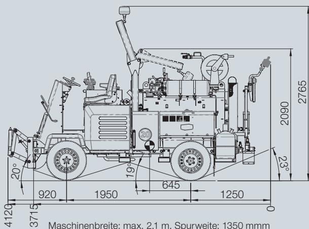
Selbstfahrende Spritzmaschine **WEIRO® TM 804 SH** mit einem Nutzinhalt von 800 l für die Herstellung des Schichtenverbundes mit polymermodifizierten Bindemitteln gemäß TL BE-StB 15 (Bitumenemulsion) und Haftklebern, ausgestattet mit Überrollschutz ROPS (klappbar), zertifiziert gemäß DIN EN ISO 3471:2010-01.
