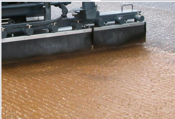
Qualitätsbestimmend: präzise Ausbringung des Bindemittels durch computergestützte Dosierautomatik (Option), die Spritzrampe mit doppelter Düsenüberlappung sorgt für ein gleichmäßiges Spritzbild
